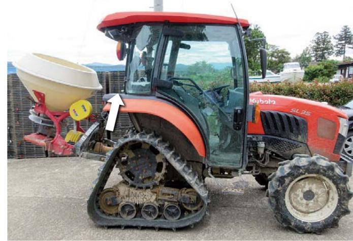
圃場へ移動するために、装着した肥料散布機を上昇させた際に、リアガラスに散布機が接触しガラスが割れた。
