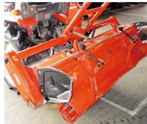
田の耕うん作業中、位置合わせの為後進した際に、目測を誤り畦畔にロータリーが接触しカバーが変形した。
