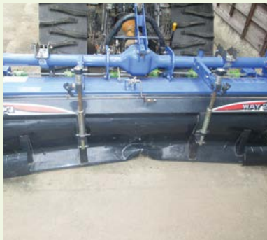
農作業場に接触しカバーが変形したロータリー
